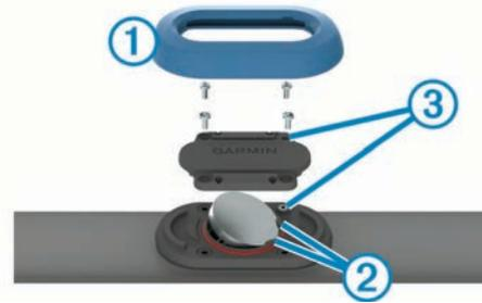
2 Utiliza un destornillador Phillips pequeño (00) para quitar los cuatro tornillos de la parte delantera del módulo.
