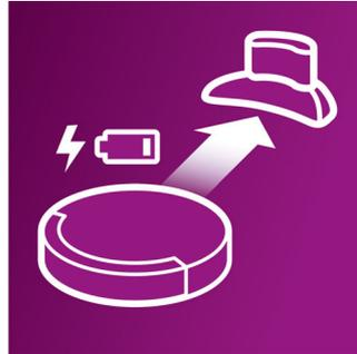
Cuando la batería está a punto de agotarse, el robot aspirador Philips vuelve automáticamente a la estación base para realizar la carga y quedar disponible para su siguiente sesión de limpieza.
